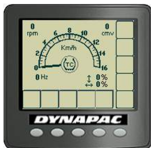
Рис. На дисплее показано включенное/отключенное состояние противобуксовочной системы
