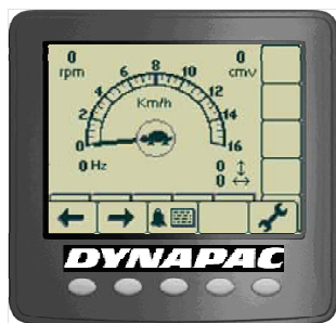
Рис. В центральной части дисплея отображается выбранный символ (заяц, вращение вальца, вращение колёс, черепаха).
