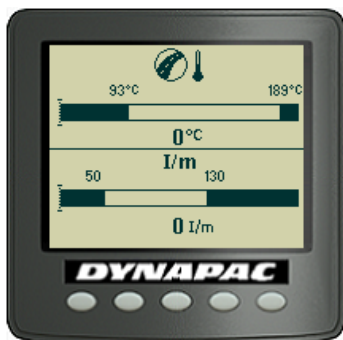
Рис. Экран температуры асфальта/ударного измерителя
